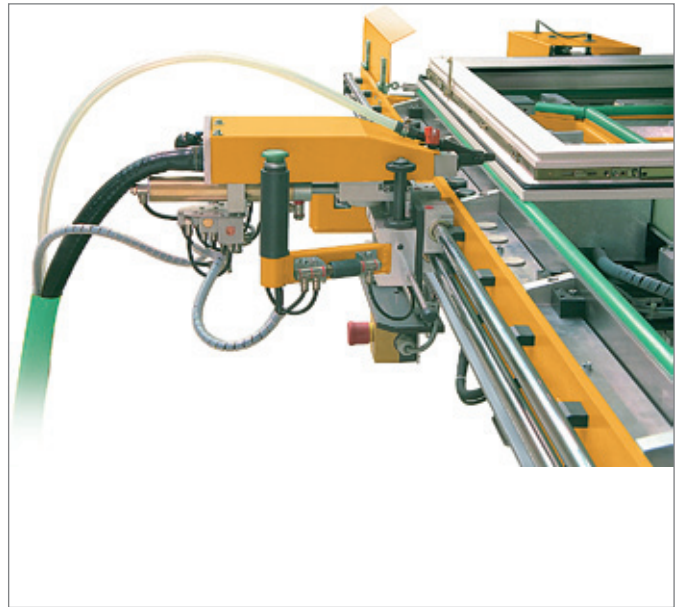
Handgeführter Vorschubschrauber mit automatischer Schraubenzuführung zum Anheften der Beschläge oder für Sonderbeschläge
