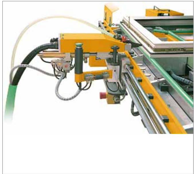
Дополнительный, в ручную перемещаемый шуруповёрт с автоматической подачей шурупов для крепления фурнитуры или нестандартных частей.
