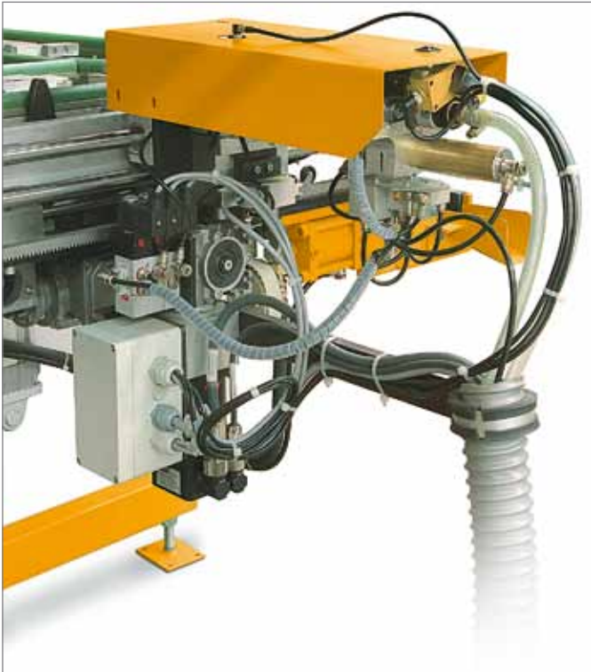
Автоматический, свободно-программируемый шуруповёрт с автоматической подачей шурупов, с отслеживанием их подачи и автоматическим моментом прикручивания.
