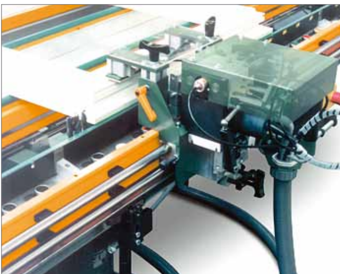
Дополнительные агрегаты: сверлильный агрегат для сверления отверстий под ручку, фрезерный агрегат для фрезеровки паза под замок с автоматической подачей.
