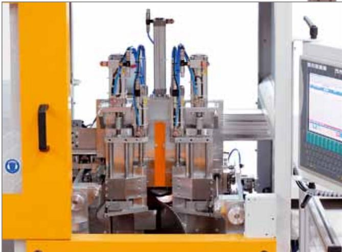
Модульное исполнение фиксаторов и пильного агрегата
